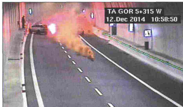
2. Un'esercitazione del rilevamento del fumo presso la galleria Gorla
