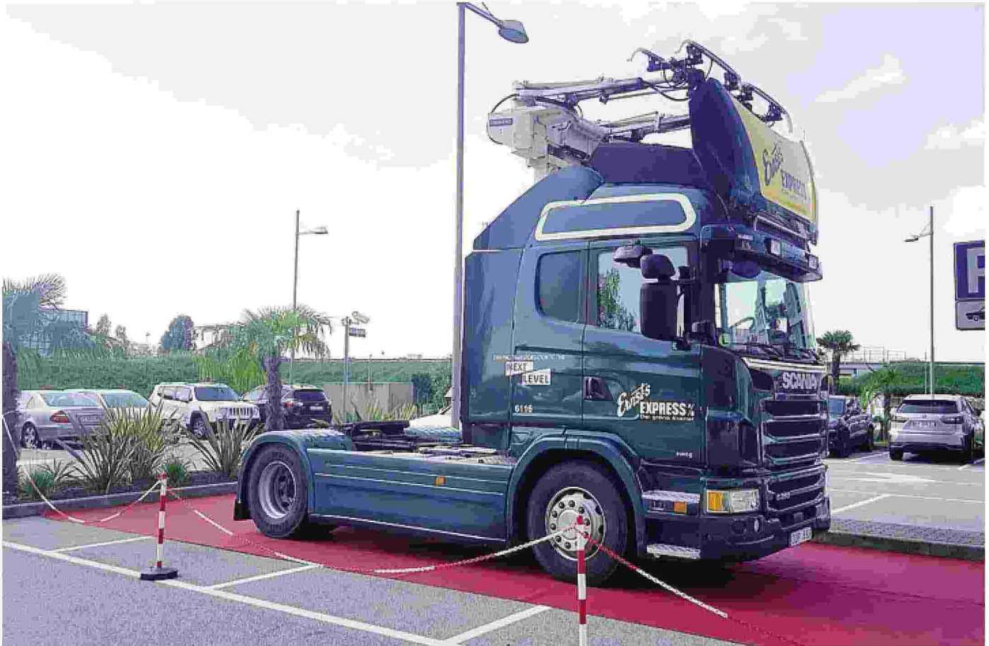
Il tir con il pantografo montato sulla cabina arrivato dalla Svezia: il mezzo ad alimentazione ibrida può sfruttare la linea elettrica
