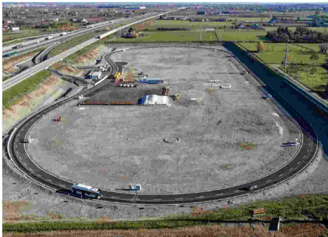
L'area nei pressi dell'autostrada Brebemi dove i mezzi elettrici, per ora in via sperimentale, potranno fare il pieno di energia restando in movimento
