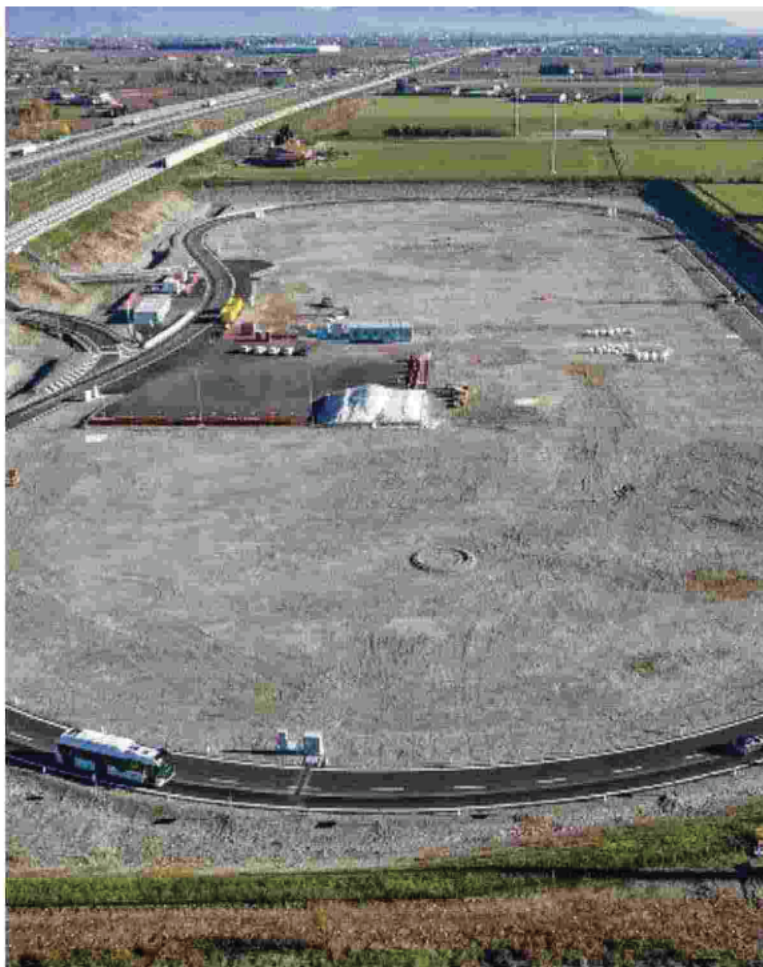
Il circuito per la ricarica elettrica a induzione dinamica, indicata da studi internazionali come strada principe per la transizione ecologica nella mobilità
