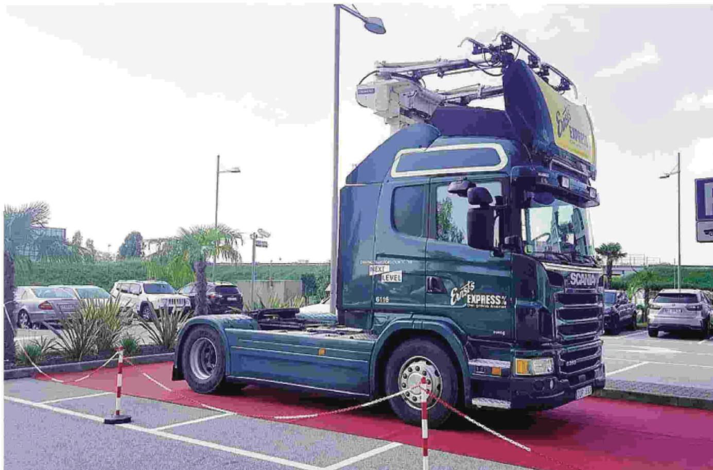
Il tir con il pantografo montato sulla cabina arrivato dalla Svezia: il mezzo ad alimentazione ibrida può sfruttare la linea elettrica
