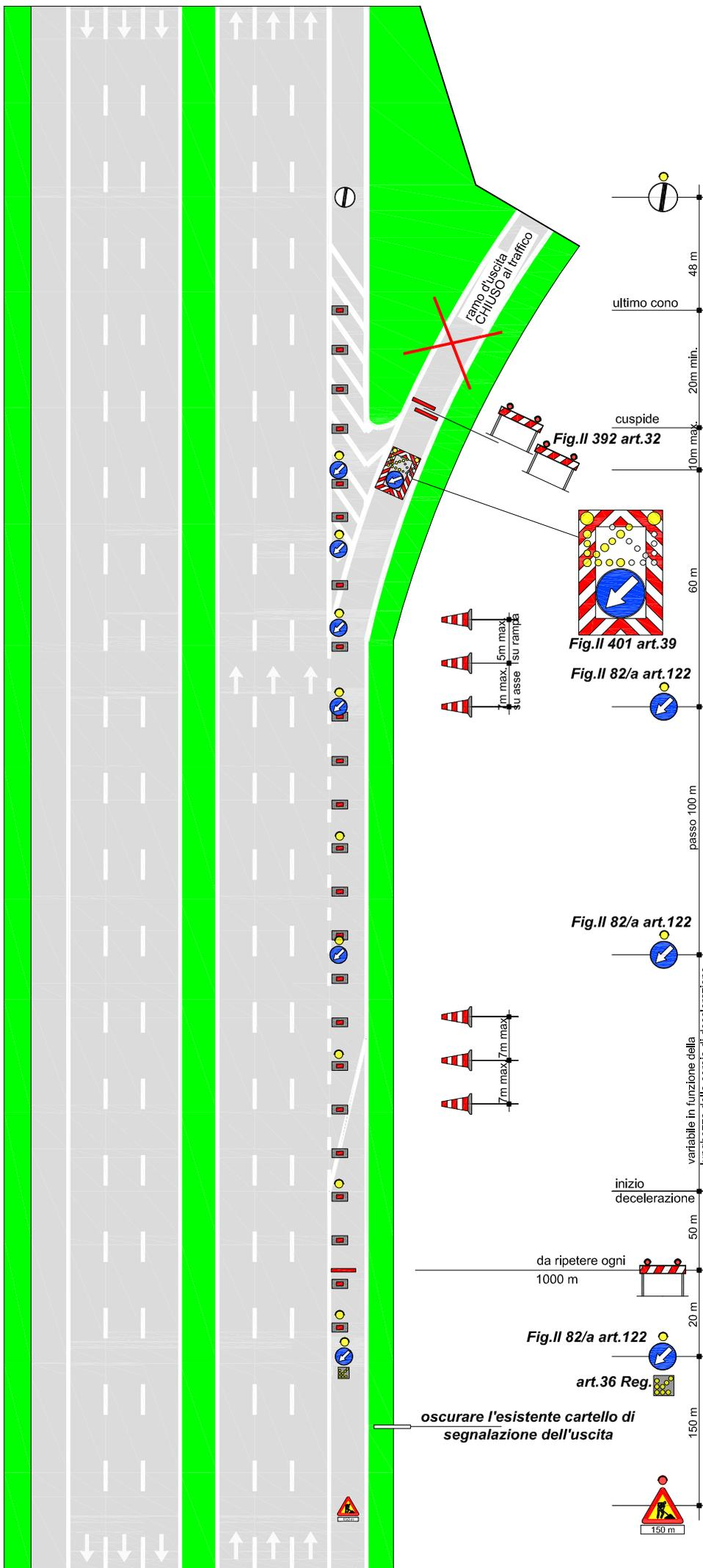
I veicoli operativi, i macchinari ed i mezzi d'opera esposti al traffico, fermi od in movimento, devono portare posteriormente il segnale di Passaggio obbligatorio per veicoli operativi (Fig. II 398) con freccia orientata verso il lato dove il veicolo può esser superato
