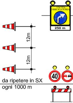
I veicoli operativi, i macchinari ed i mezzi d'opera esposti al traffico, fermi od in movimento, devono portare posteriormente il segnale di Passaggio obbligatorio per veicoli operativi (Fig. II 398) con freccia orientata verso il lato dove il veicolo può esser superato
